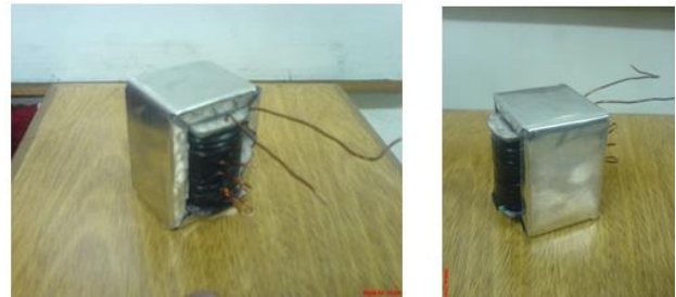
Figura 10 Fotos del transformador diseñado y construido, listo para ser acoplado al mango del pirógrafo
